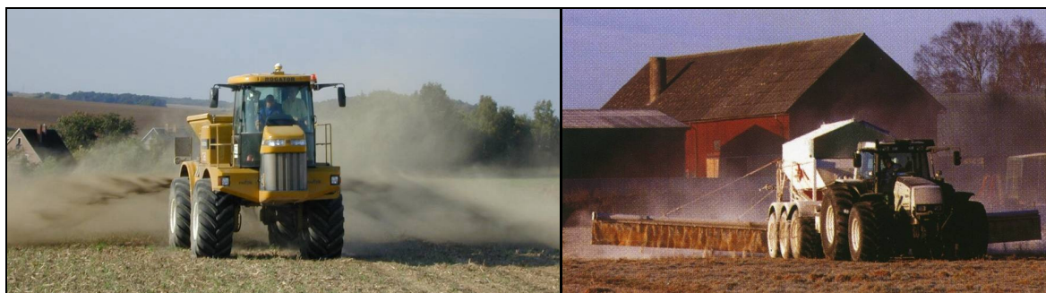
Foto 3-4. Sentrifugalspreiarar for pulvermateriale som biokol, udempa spreiring til venstre, støvdemping med skjørt til høgre (foto: Bredal Maskin AS, Danmark)
