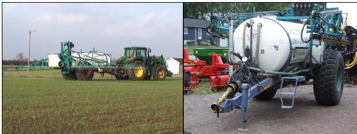
Foto 1-2. Sprøytevogner med sprøytebom 20 m, nytta for Flex-gjødsel (foto: Flex Agri AS).
