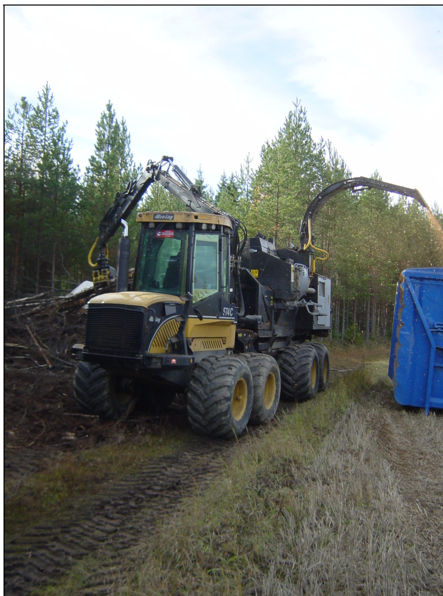
Foto 8. Flising av grot ved åkerkant ved Flisa, Vermundsjøen Skogsdrift, okt. 2010.
